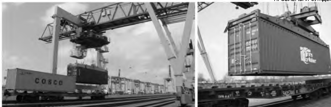
1-расм. Юкларни бир колея энидаги вагондан бошқа колеядаги вагонга юклаш
