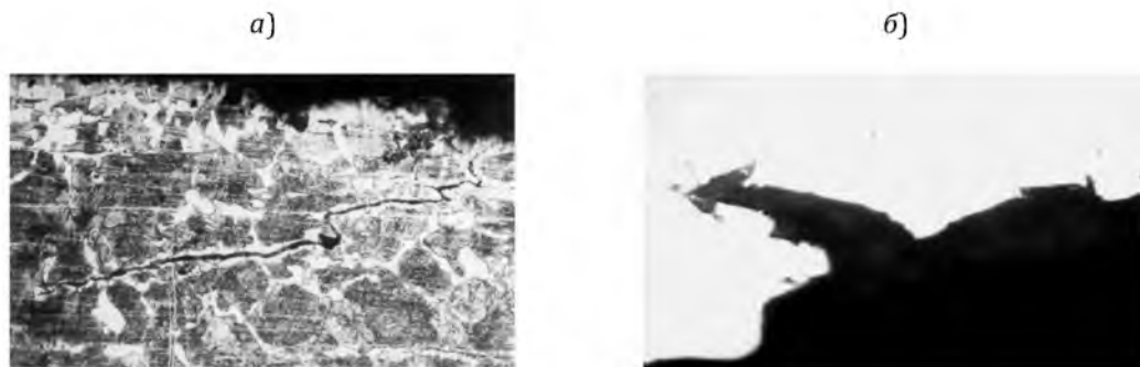
Рис. 4. Окисленная поверхность трещин в ободьях колес; x200
